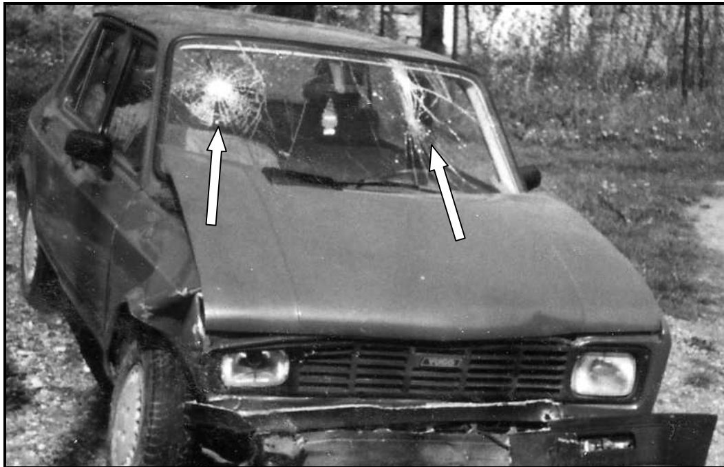
Slika br. 13 – Oštećenja prednjeg vetrobranskog stakla
