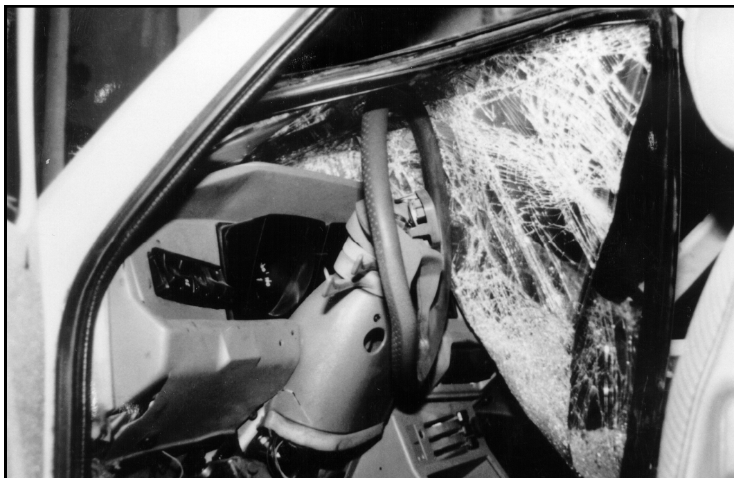
Slika br. 15 – Oštećenja točka upravljača JUGA
